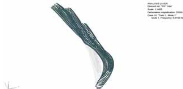
Fig. 19. Forma modal del primer modo lateral.
