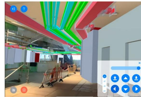
现场工程师、技术人员和设施管理人员, 可通过智能手机应用程序访问专为AIRSIDE项目设计的建筑维护平台, 于虚拟环境中查看机电系统详细信息。
